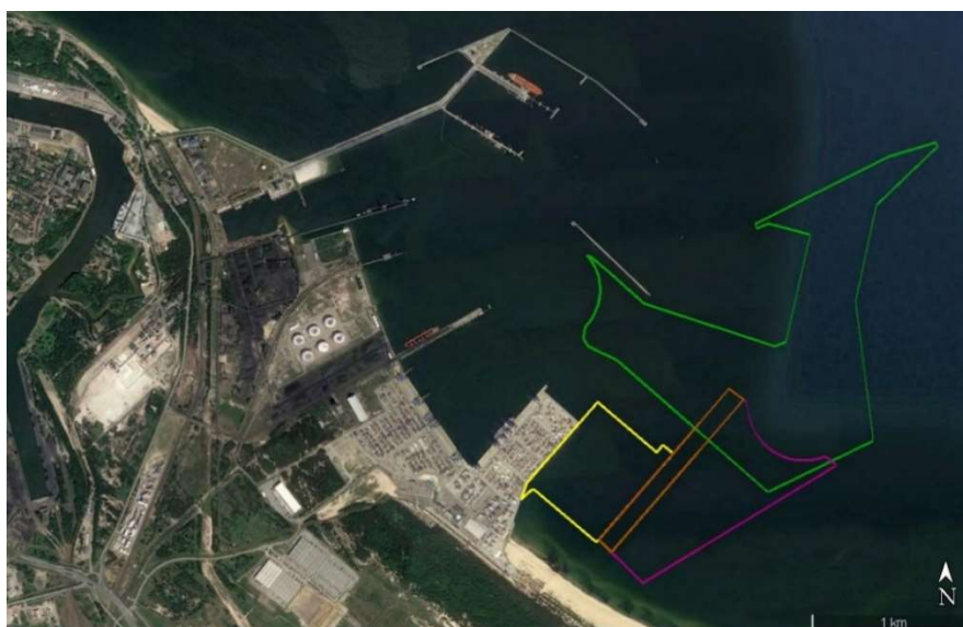
Rysunek 1.4 Lokalizacja proponowanego terminalu T3 (żółty), pogłębienia dla obszaru cumowania T3 (fioletowy), strefy buforowej obszaru cumowania (brązowy) oraz kanału podejściowego i manewrowego (zielony)
