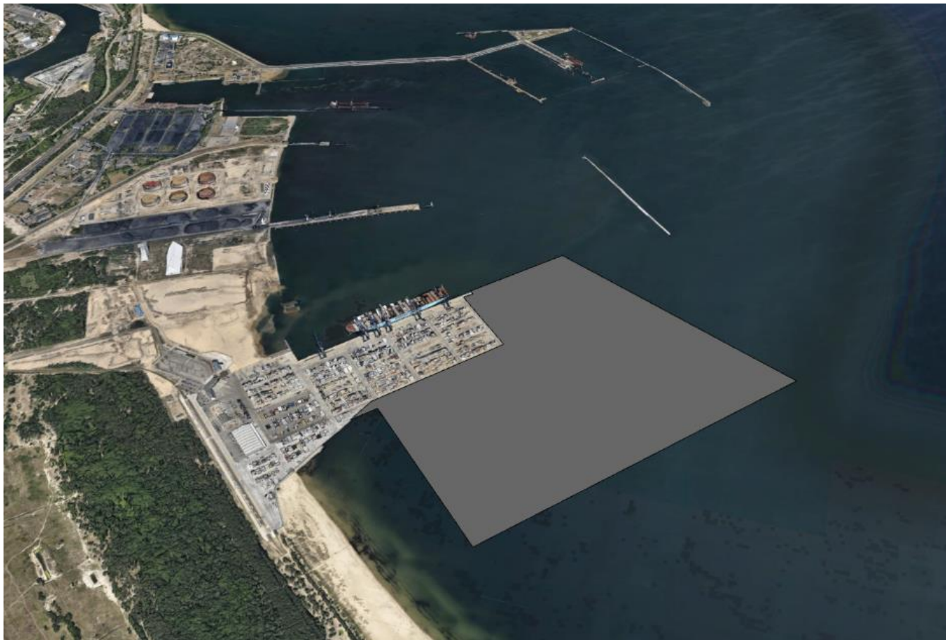
Rysunek 108 Wizualizacja przekształcenia nabrzeża DCT po realizacji planowanej rozbudowy terminala DCT3 - widok z lotu ptaka od strony wschodniej. Źródło: opracowanie własne na podstawie podkładów GoogleEarth
